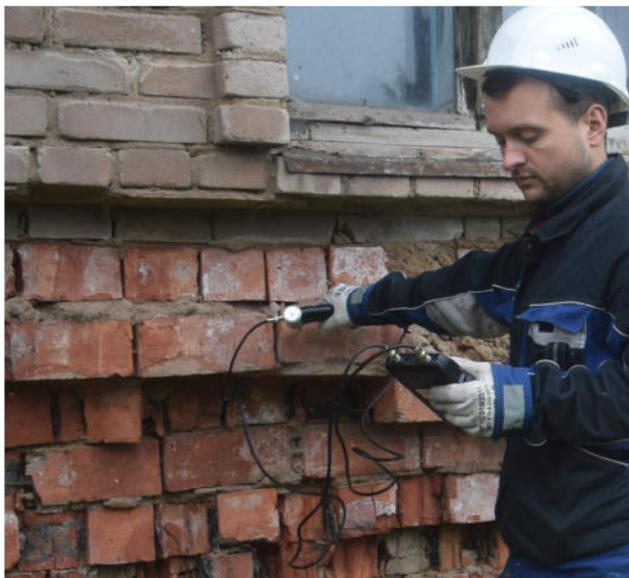
Рис. 7 – Измерение прочностных характеристик конструкций ультразвуковым способом
